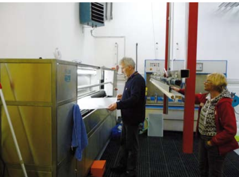
Ein Vollautomat reinigt Flächenvorhänge, Rollos, Plissees, Screenflächen und technischen Textilien.
